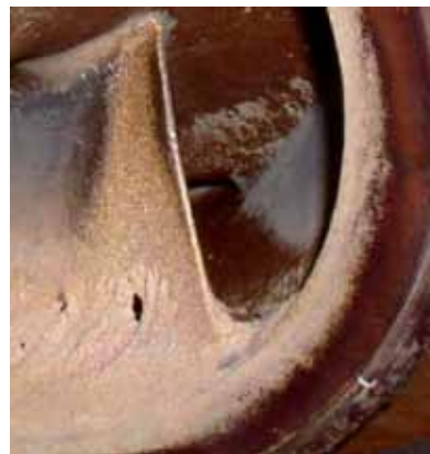
Рис. 1.5: Рабочее колесо с повреждениями, вызванными кавитацией (Источник: Справочник по центробежным насосам KSB).
