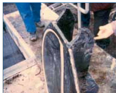
Рис. 1-с: Обратный клапан DN 800 после скачка давления в напорной трубе
