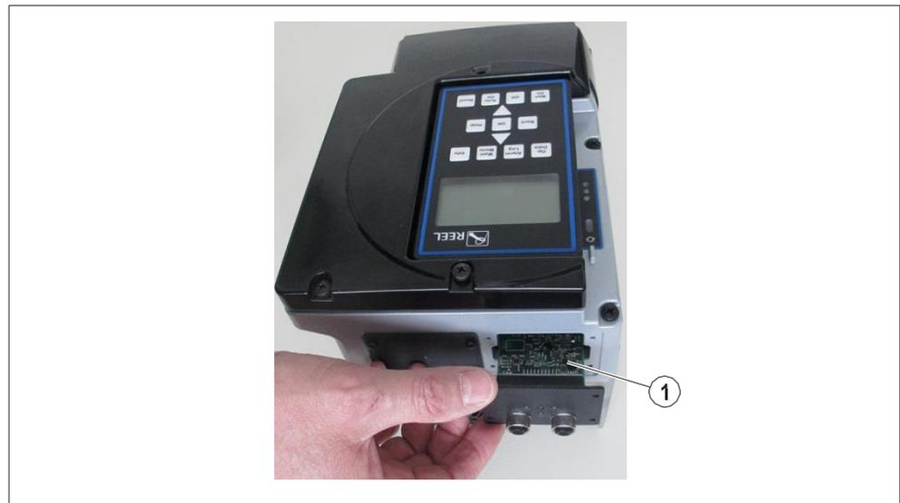
4) Fissare il modulo usando le 4 viti a croce (**Figura 4**).
