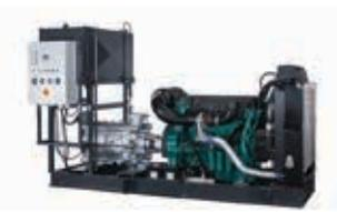
Dieselmotorgetriebene Pumpenaggregate für den Dauerbetrieb kommen zum Einsatz, wenn ein dauerhafter Betrieb unabhängig der Stromversorgung gewährleistet werden muss. Hier abgebildet, ein drehzahlgeregeltes Diesel-Pumpenaggregat mit Hochdruckpumpe zur Reinigung großer Rohrleitungssysteme. Die Motor Kühlung erfolgt über einen Radiator und ist somit unabhängig vom Fördermedium.
