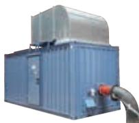
Fest installierte Pumpenaggregate im Container haben den Vorteil, dass sie bereits anschlussfertig zur Verfügung stehen. Damit entfällt ein Großteil des Installationsaufwands auf der Baustelle. Eine anwendungsspezifische Auslegung für ein oder mehrere diesel- oder elektromotorgetriebene Pumpenaggregate ermöglicht ein hohes Maß an Flexibilität.
