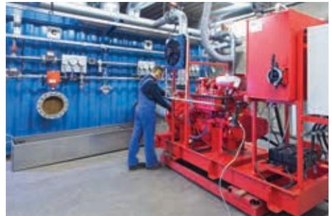
Qualitätskontrolle eines Diesel-Pumpenaggregates auf werkseigenem Prüfstand
