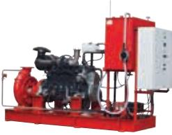
Das VdS-Portfolio umfasst Pumpenaggregate mit 5,5 kW bis 300 kW Antriebsleistung. Ein breites Programm an zugelassenen KSB-Sprinklerpumpen sowie eine selbst entwickelte Steuerung im zertifizierten KAGEMA-Schaltschrank aus eigener Fertigung stehen für Anlagenwissen aus einer Hand. Ansteuerungen von Nebenaggregaten können sowohl im Diesel- als auch im Elektropumpen-Schaltschrank installiert werden.
