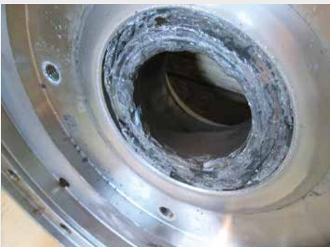
Zerbrochene Lagerbuchse der Prozesspumpe
