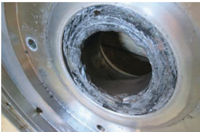
Zerbrochene Lagerbuchse der Prozesspumpe
