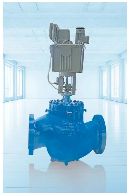
Ventil der Baureihe MIL 41000, 20", 600# nach ASME mit elektro-hydraulischem Stellantrieb für ein Projekt zur Pipeline-Erweiterung in einer Raffinerie.
