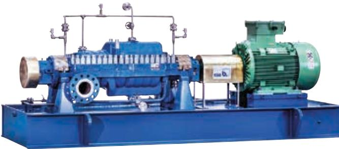
**Bomba multicelular, partida axialmente, con rodamientos a ambos lados, de tipo heavy duty según API 610 (BB3).**
