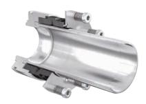
Die einfachwirkende Gleitringdichtung ist optimal an den Einbauraum der Pumpe angepasst. Die großen außenliegenden Federn sind unempfindlich gegen Verunreinigung und gewährleisten durch gleichmäßige Flächenpressung der Gleitflächen lange Standzeiten. Optional ist die Dichtung auch als Doppeldichtung 4KD verfügbar.
