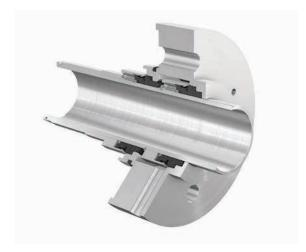
Doppeltwirkende Cartridgedichtung speziell für Anwendungen mit negativem Saugdruck. Der optimierter Spülkanal begünstigt das Freispülen von möglichen Feststoffen an der Produktseite der Gleitringdichtung.
