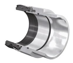
Das Design der Dichtung ist robust und praxisgerecht, wodurch alle Anwendungsbereiche der Omega durch diesen Dichtungstyp abgedeckt werden können. Die einfachwirkende Gleitringdichtung beinhaltet bereits die Abstandshülse der Pumpe und ist somit ohne Einstellmaß montierbar.
