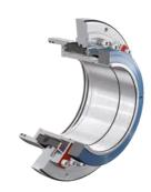
Die einfachwirkende Cartridge-Dichtung ist speziell für Anwendungen mit hohen Feststoffgehalten konzipiert. Optional kann eine Pflegespüleinrichtung angeschlossen werden. Dadurch werden Leckage-Produkte weggespült und die Standzeit der Dichtung signifikant erhöht.
