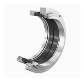
Die 4STC ist eine stationäre Komponentendichtung für die Pumpenbaureihen Amarex KRT, Sewatec und Amacan. Die Federn liegen außerhalb des Fördermediums, wo sie vor Verunreinigungen geschützt sind. Der Gleitring der Dichtung ist gegen Herausfallen gesichert, wodurch die Montage bei vertikalem Einbau sicherer wird.
