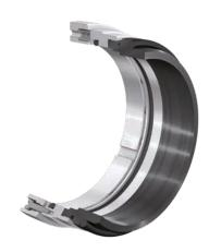
Zusammen mit der Wellenschutzhülse der Pumpe kann die 4RD ähnlich wie eine Patrone montiert werden. Der Gleitring ist in den metallischen Gleitringträger eingeschrumpft. Dies gewährleistet eine gleichmäßige Anlage vor allem bei hohen sowie wechselnden Drücken und Temperaturen.
