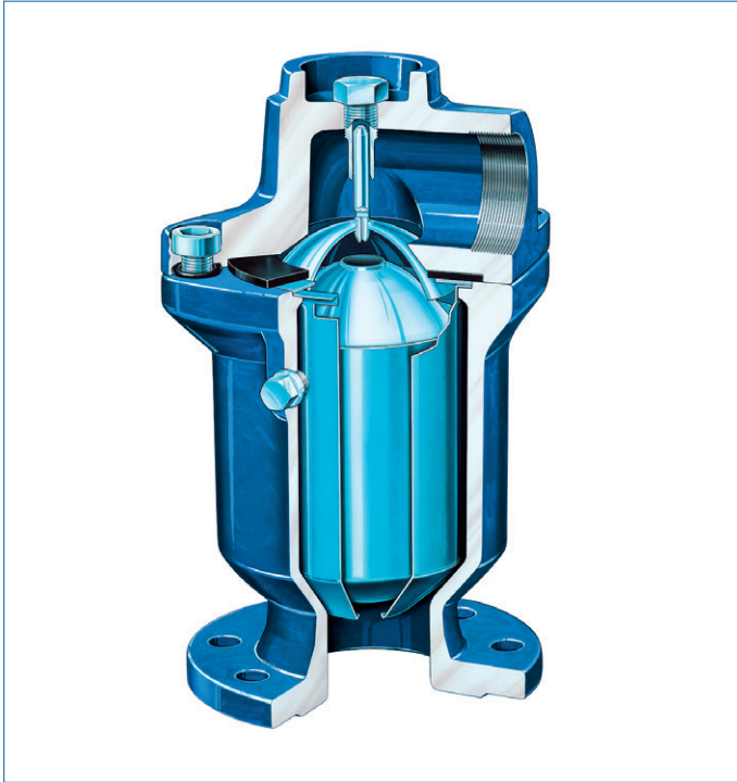
Abb. 18: Duojet – Be- und Entlüftungsventil mit Medium betätigtem Einkammer-Ventil. Großer Entlüftungsquerschnitt zum Be- und Entlüften großer Luftmengen beim Anfahren oder Abschalten von Pumpenanlagen. Kleiner Entlüftungsquerschnitt zum Entlüften kleiner Luftmengen während des Betriebes unter vollem inneren Überdruck. (Mit freundlicher Genehmigung der VAG-Armaturen GmbH)
