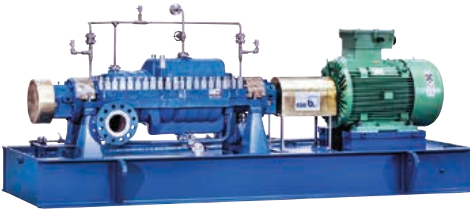
Heavy-duty, axial geteilte, beidseitig gelagerte, mehrstufige Pumpe nach API 610 (BB3)
