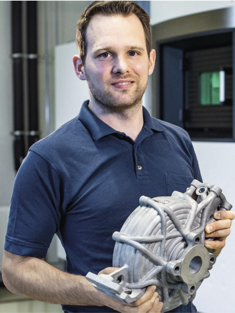
Optimisé par la fabrication additive : un gain de poids de 57 % a été obtenu en fabriquant ce corps de pompe par un procédé de fusion sur lit de poudre.
