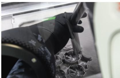
À l'issue du processus de fabrication, on aspire la poudre inutilisée qui n'est pas entrée en fusion afin de l'extraire des pièces internes. Les étapes consistant à scier les composants fabriqués pour les détacher du socle et à tamiser la poudre restante pour qu'elle puisse être réutilisée sont réalisées automatiquement dans un système fermé.
