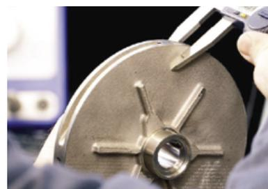
Après son achèvement, le composant est soumis à des tests de qualité approfondis. Le contrôle qualité qui accompagne le processus comprend des analyses de poudre, des essais mécaniques et chimiques complets ainsi que des contrôles dimensionnels.
