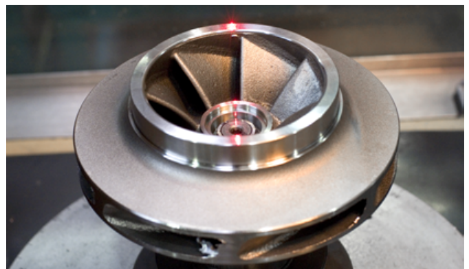
Roue pour pompe RPK reconstruite en Express Line avec le procédé de Reverse Engineering
