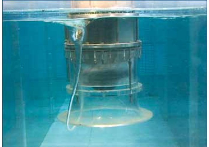
Abb. 58: Laboraufnahme eines Oberflächenwirbels Typ 6
