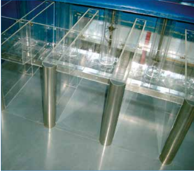
Abb. 56: Acrylmodell einer Amacan P-Pumpstation
