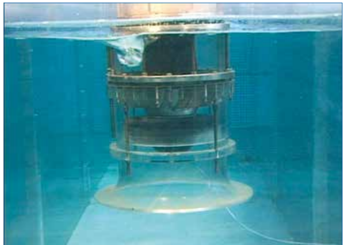
Abb. 59: Laboraufnahme eines Oberflächenwirbels Typ 3
