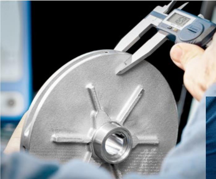
Die fortschrittlichen additiven Fertigungsverfahren ermöglichen die Produktion von komplexen Bauteilen, beispielsweise Pumpengehäuse mit integrierten Kühl- oder Heizkanälen. ↓
