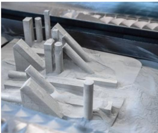
Bei der metallbasierten additiven Fertigung im Pulverbettverfahren entstehen die Werkstücke Schicht für Schicht aus Pulver.
