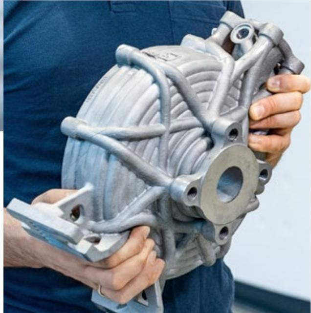
Einsatz, in der das geförderte Medium auf einer bestimmten Temperatur gehalten werden muss, beispielsweise beim Transport von Pflanzenöl und Natronlauge. Bisher war die Produktion eines solchen Teiles nicht möglich, stattdessen schweißten die Hersteller die Kanäle nachträglich auf. Das additive Fertigungsverfahren ermöglicht nun die Produktion wie „aus einem Guss“.
