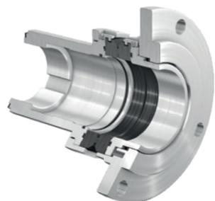
Particolarmente robusta, la tenuta meccanica 4KST è progettata per operare a pressioni e temperature estreme, integrandosi perfettamente così con le pompe per acqua calda HPH. Il design speciale provvisto di bussola elimina la necessità di una regolazione assiale; la tenuta è sempre perfettamente posizionata sull'albero pompa.
