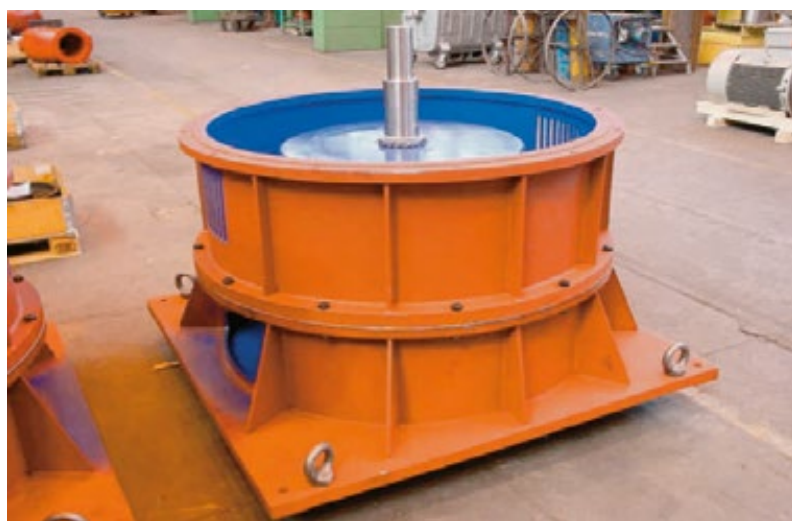
Illustration 8.1.3-b : Volant d'inertie vertical (entraînement par l'intermédiaire d'un arbre articulé, D = 790 mm).
