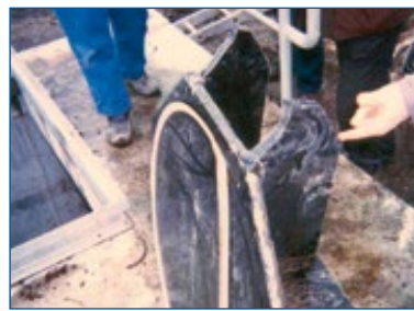
Illustration 1-c : Dispositif anti-retour DN 800 après coup de bélier dans une tuyauterie sous pression
