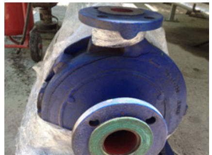
Photo : corps de pompe déchiré
