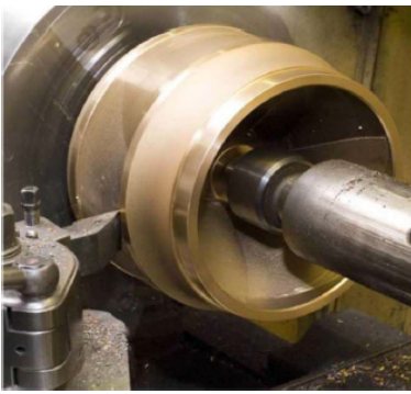
Photo : Usinage d'une roue
