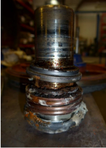
Photo: "Cette garniture d'étanchéité réclame un minimum d'attention"
