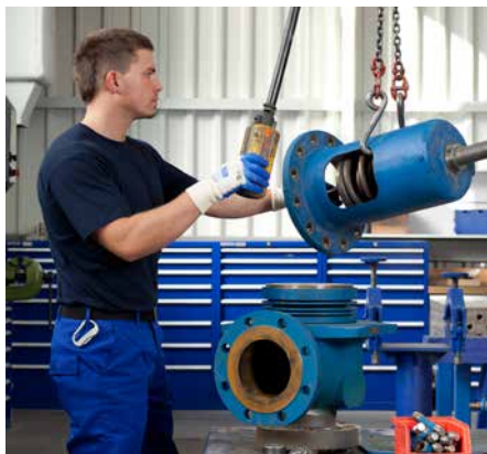
Réparation d'une soupape
