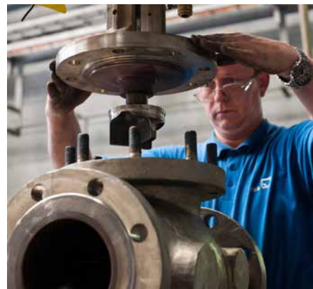
Remontage d'une vanne de régulation
